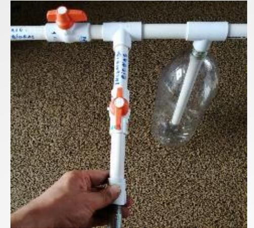
Foto. Llaves de paso, quemador y válvula de presión
