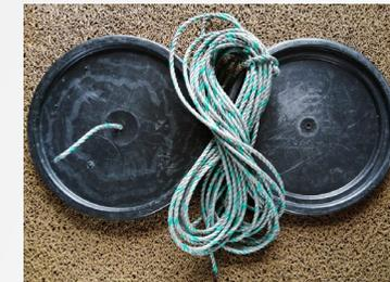
**Foto. Mezclador o Agitador artesanal:** usado para mover la Biomasa dentro del Biodigestor, esta compuesto por dos tapas de cuñete o galón, y un lazo, que se instalan dentro del mismo, antes del amarre de los tubos de entrada y salida.
