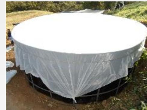
Fotos: Paso 2. Tanque de Estabilización cubierto con tela muselina, montado bajo techo..
