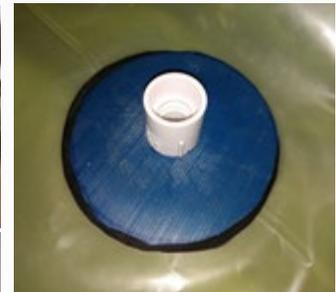
El buje es para pasar de diámetro de 3/4" a 1/2" y continuar la línea de biogás en tubo PVC de 1/2".
