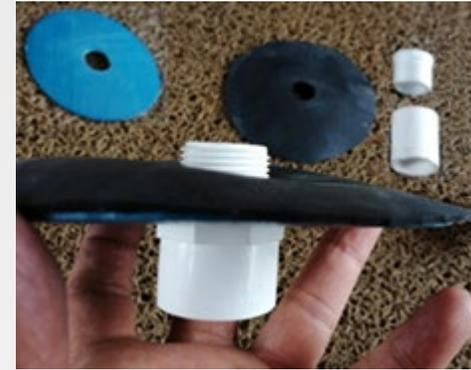
**Armado:** Se hace el acople del adaptador al disco plástico y luego va el empaque neumático, para pasarlo desde adentro por el orificio del Biodigestor (**parte interna de la válvula de salida**).
