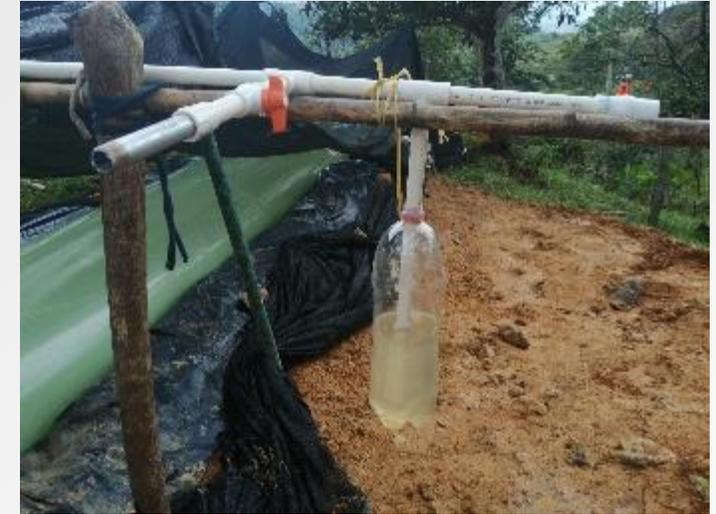
Foto. Línea básica de Biogás: Válvula de Seguridad con Agua para darle presión al sistema de biodigestión.
