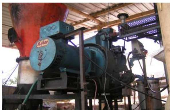
Gasificador con Motor de 10 hp y Generados de 5 kwat, Fundación UTA, Tosoly, 2015.
