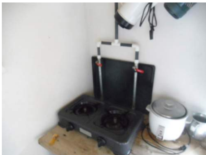
Foto 3. estufa adaptada a biogás.
