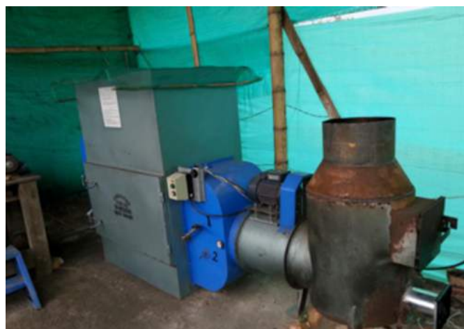
Secador de café adaptado a Gasificación, Fundación UTA, Tosoly 2015.
