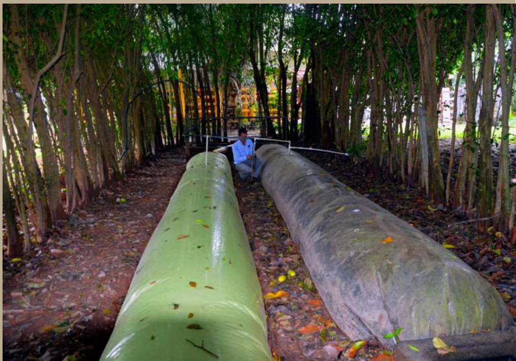
Biodigestores plásticos de flujo continuo, La Cosmopolitana, Restrepo, Meta.
